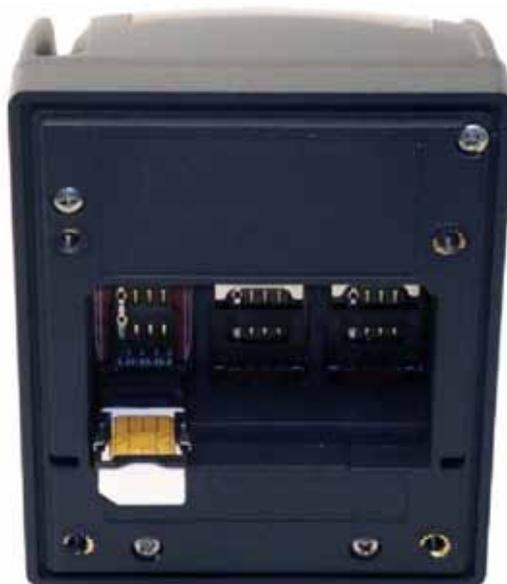
3. 設置枠をカチッという音がするまで押さえ、元の位置に戻します。
